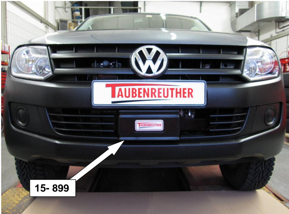
Hier sehen sie den fertig montierten Seilwindenanbausatz.
