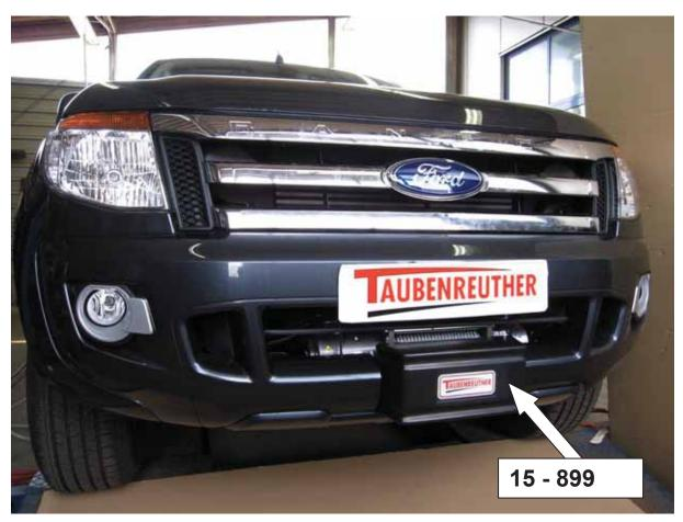
Hier sehen sie den fertig montierten Seilwindenanbausatz. Bevor sie mit der Montage beginnen, lesen sie bitte diese Anleitung und die Bedienungsanleitung der Seilwinde gut durch. Achtung:
