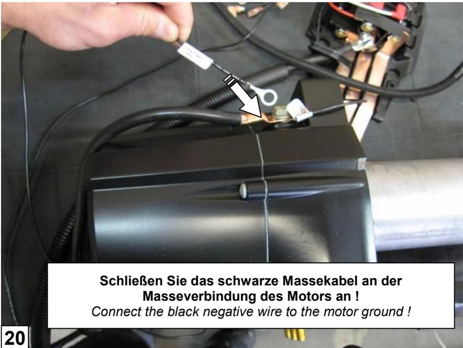
**Schließen Sie das schwarze Massekabel an der Masseverbindung des Motors an !**
