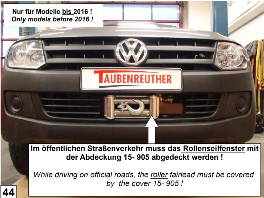
Im öffentlichen Straßenverkehr muss das Rollenseifenster mit der Abdeckung 15- 905 abgedeckt werden !
