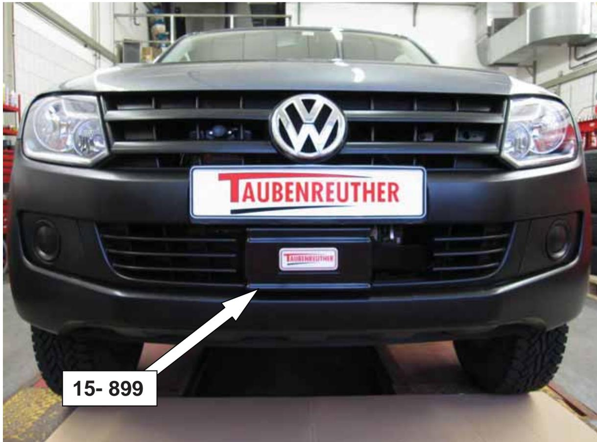
Hier sehen sie den fertig montierten Seilwindenanbausatz.
