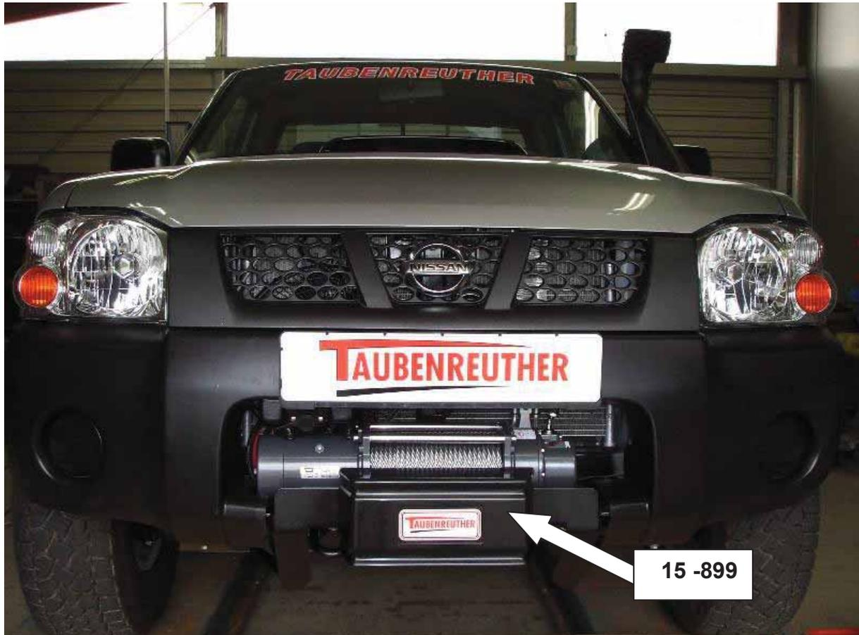
Hier sehen sie den fertig montierten Seilwindenanbausatz.
