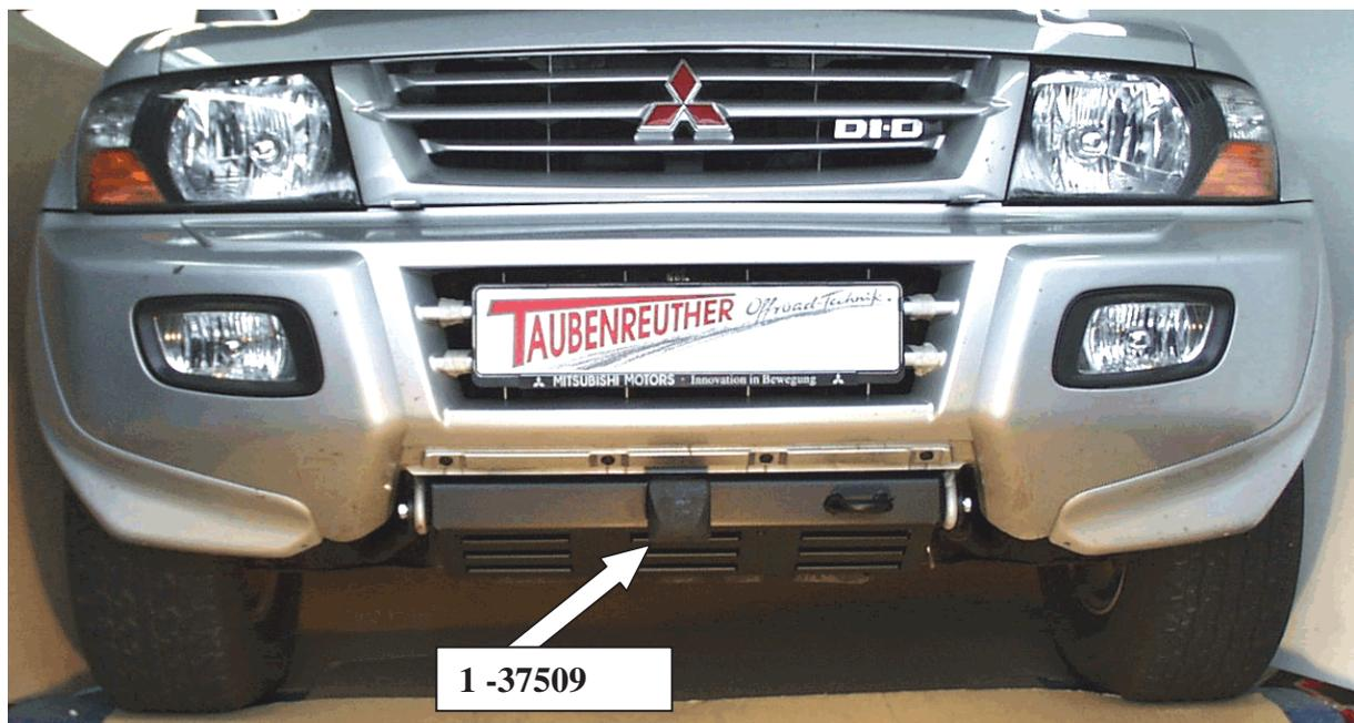
Hier sehen sie die fertig montierte Frontaufnahme, bitte lesen sie diese Anleitung und das Benutzerhandbuch der Seilwinde gut durch.
